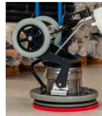
Kippbare Deichsel zur Erhöhung des Anpressdruckes.
