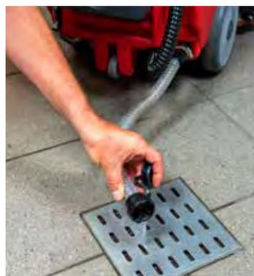
Der Frischwassertank kann restlos abgelassen werden.
