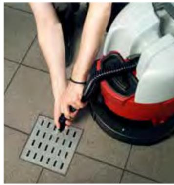
Der Schmutzwassertank kann über den Abwasserschlauch entleert werden.
