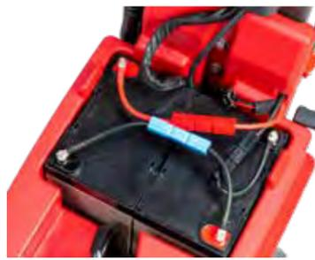
Die wartungsfreien 33 Ah Gel-Batterien sind über die Schnellkupplungen werkzeuglos entnehmbar.
