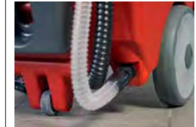
Über das Stützrad kann die Maschine einfach transportiert und Bürsten schonend abgestellt werden.
