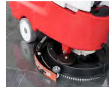
Saugbalken schwenkt automatisch in die Arbeitsrichtung.
