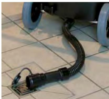
Schmutzwasser-Ablassschlauch zum bequemen, restlosen Entleeren des Behälters.
