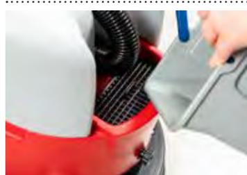
Einfache Befüllung des 15 Liter Frischwassertanks.
