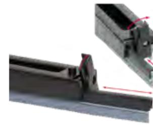
Einfacher, werkzeugloser Wechsel der Gummilippen.
