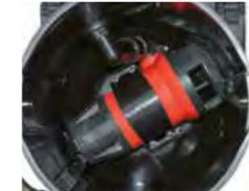
Die leistungsstarke Pumpe im Inneren des Saugers hat eine Förderleistung von bis zu 14.000 Liter Schmutzwasser pro Stunde.
